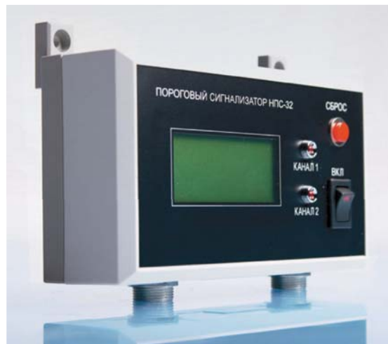
■ Сигнализатор радиоактивного Излучения НПС-32
